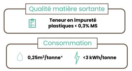
\*Le bio-SV n'a pas besoin d'ajout d'eau pour fonctionner. Il est possible d'ajouter de l'eau sale, pour limiter la consommation d'eau
